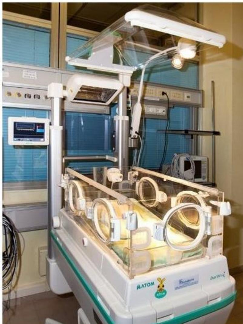
L'incubatrice Atom è anche regolabile in altezza, per offrire migliore operabilità ai singoli medici ed è possibile anche trasformazione a "cielo aperto" per un più comodo accesso a più operatori.
